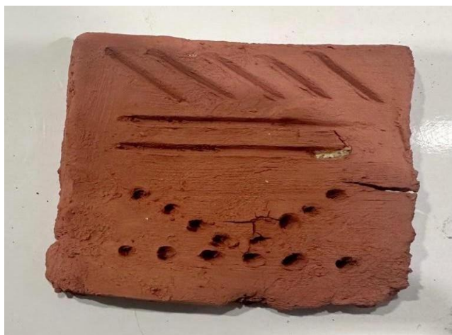
Görsel 1: Orijinal İzmit Körfezi dip çamurunun elle şekillendirilmiş ve 930°C’de sinterlenmiş hali.
